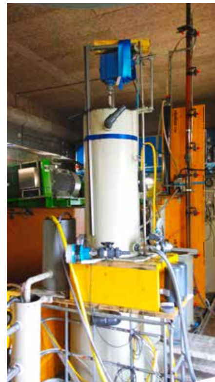
■ Pilotanlage auf dem Standort ProRhenon (links: SBR, rechts: MV-Stufe).
